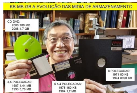
El ingeniero Rotalatino Roberto Watanabe, BRASIL , considera increíble que en la década de 1970, un simple disquete podía caber 80.000 caracteres u 80 KB en un disquete de 8 pulgadas. Hoy, 4,7 GB caben en un solo DVD, lo que equivale a 58.850 disquetes de 8 pulgadas.
